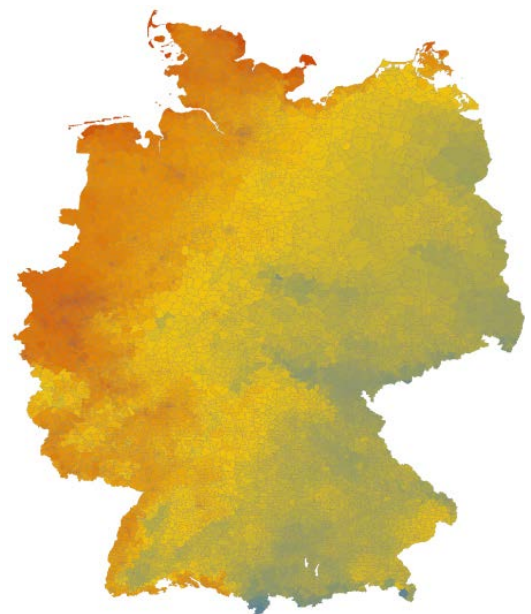
Grafik 2 • Da Deutschland verschiedene Klimabereiche hat, wird die Heizlast jeweils individuell für einen bestimmten Standort bestimmt. Als Grundlage dafür dienen sogenannte Normaußentemperaturen, die in der Norm DIN/TS 12831-1:2020-04 festgelegt wurden. Bild: bwp
