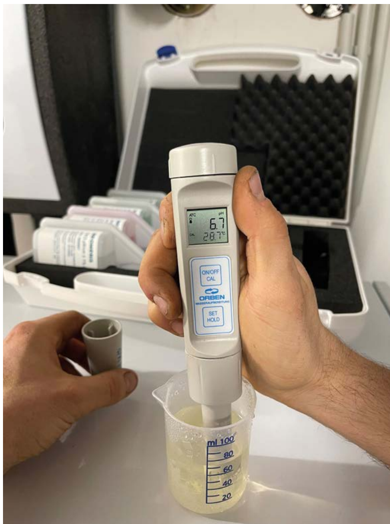
Bild 2 • Unterschrittener pH-Wert: Er sollte 8,2 bis 9,0 bei Aluminiumkomponenten im System sowie 8,2 bis 10,0 bei sonstigen Werkstoffen betragen.
