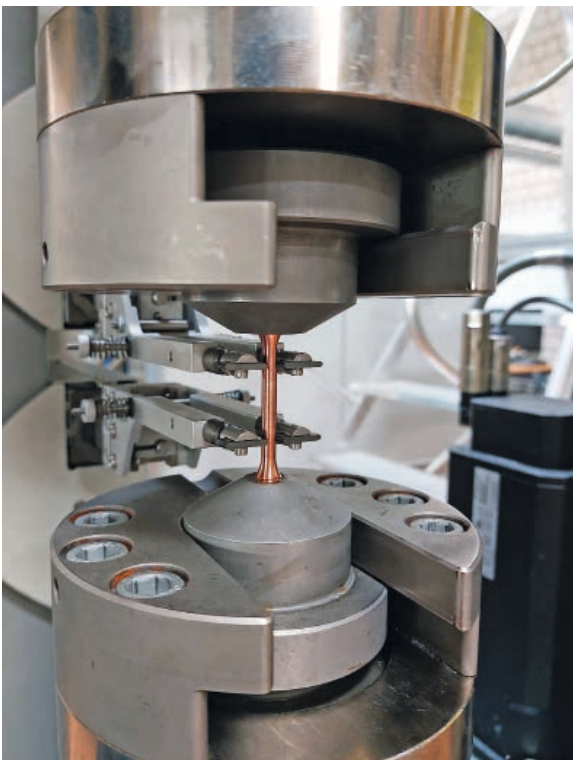
Kupfer-Probe im Zugversuch: Wasserstoff ist für Kupferwerkstoffe kein Problem.
