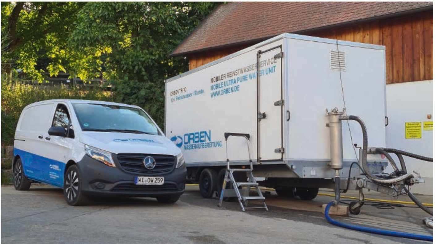
▲ Mobile Wasseraufbereitung für die schnelle und normgerechte Aufbereitung des Heizwassers direkt vor Ort. Bild: Orben
