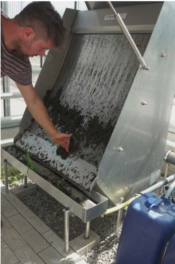
Bild 6 • Restwasser vom Fluten der Pflanztische fließt in einen separaten zentralen Auffangbehälter zurück. Unterwegs werden Substratpartikel in einem sogenannten „Hollandfilter“ ausgesiebt. Der Rücklauf einschließlich gelöster Zugaben wie Düngemittel wird zur Bewässerung im geschlossenen Kreislauf „recycelt“. Bild: König
