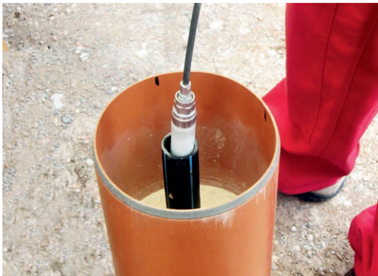
◀ Bild 5 • Mit Hilfe eines Sensors, der Meter für Meter in die Erdwärmesonde (hier zur Demonstration nur ein einfaches Rohr) eintaucht, lässt sich die Qualität der eingefüllten Suspension messen.
