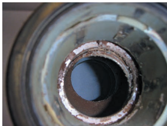
Bild 1 • Der innere Teil eines Kugelventils, die Verkrustung verhindert die Bewegung des inneren Teiles.
