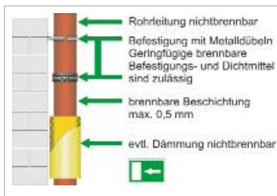
◀ Bild 6 • Freie Verlegung von nichtbrennbaren gusseisernen Abflussrohrsystemen in Flucht- und Rettungswegen.
