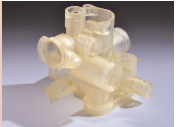
Bild 1 • Hydraulische Vorlaufeinheit aus Kunstharz mit zahlreichen Hinterschnitten
